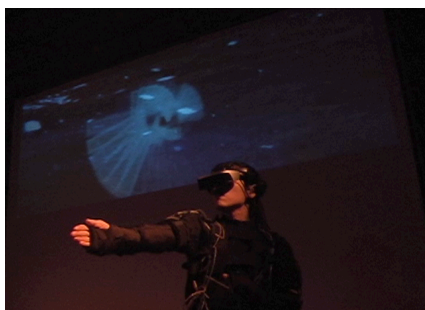
センサーは関節の曲げ具合によって電気信号を変化させる
